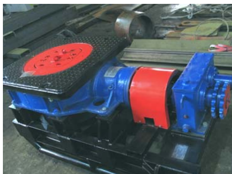
РОТОРНАЯ УСТАНОВКА РЕВЕРСИРУЕМАЯ (с редуктором реверсирования и датчиком ДМР)
